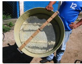
Oprema za vrcanje od galvaniziranog metala sa premazom od laka trebala bi biti obložena pčelinjim voskom
