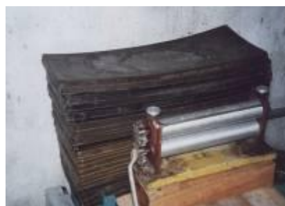
Kućna izrada satnih osnova – ovaj vosak se pokvario zbog topljenja u čeličnim posudama
