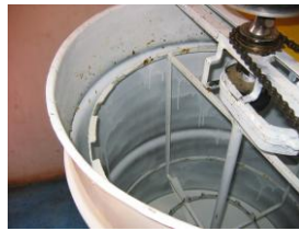
Oprema za vrcanje od galvaniziranog metala sa premazom od laka trebala bi biti obložena pčelinjim voskom
